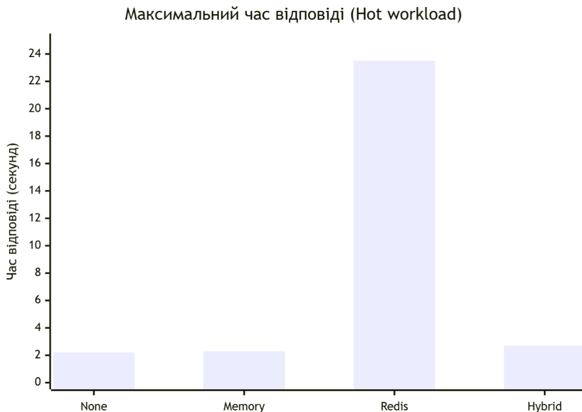
Рисунок 4.6 – Порівняння максимального часу відповіді для hot workload
