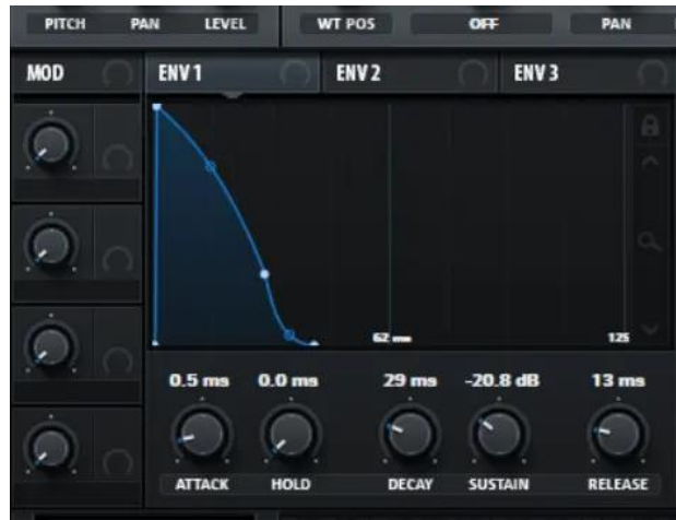
Рисунок 3.6 – Налаштування синтезатора для відтворення звуку кнопки (другий шар)
