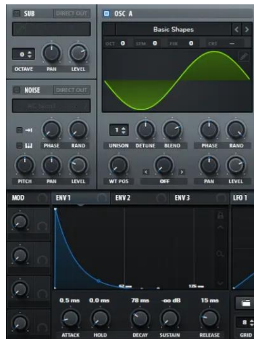
Рисунок 3.5 – Налаштування синтезатора для відтворення шару металевого імпакту
