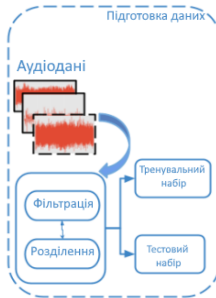
Рисунок 4.3 – Алгоритм адаптації звукозапису БПЛА для систем реального часу
