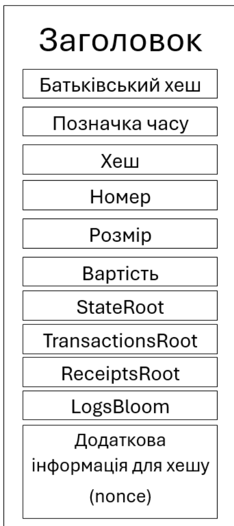
Рисунок 3.5 – Схема заголовка виконання транзакції
