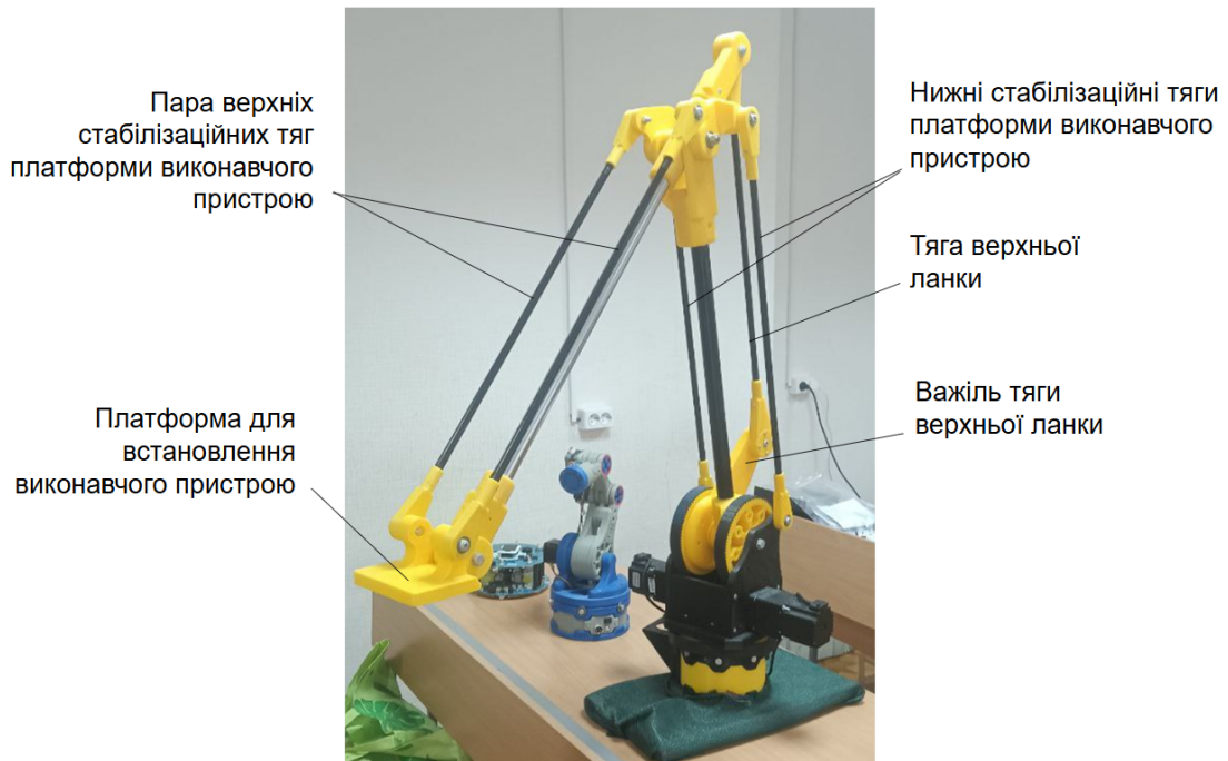
Рисунок 2.6 – Принцип організації горизонтальної стабілізації платформи для встановлення виконавчого пристрою
