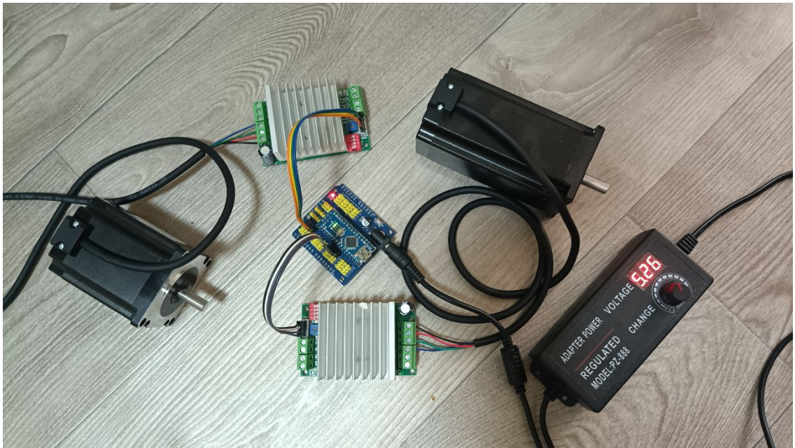
Рисунок 4.13 – Зовнішній вигляд зібраного макету модуля керування промисловим маніпулятором.
