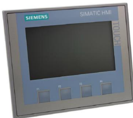
Рисунок 4.17 – Загальний вигляд вибраної панелі оператора Siemens SIMATIC HMI
