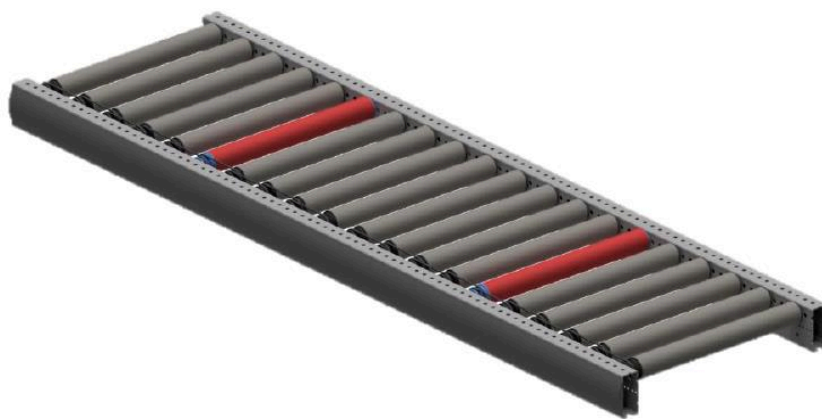
Рисунок 4.7 – Загальний вигляд прямого приводного роликового конвеєра 487
