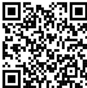
Рисунок 3.3 – QR-код у вигляді коду Ріда-Соломона з 4 надмірними символами, який містить текст «Test object No. 1»
