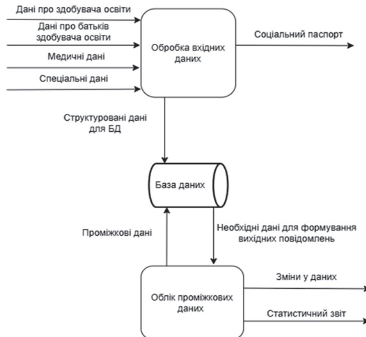
Рисунок 2.3 – Діаграма потоків даних модуля «Моніторинг персональних даних учнів»
