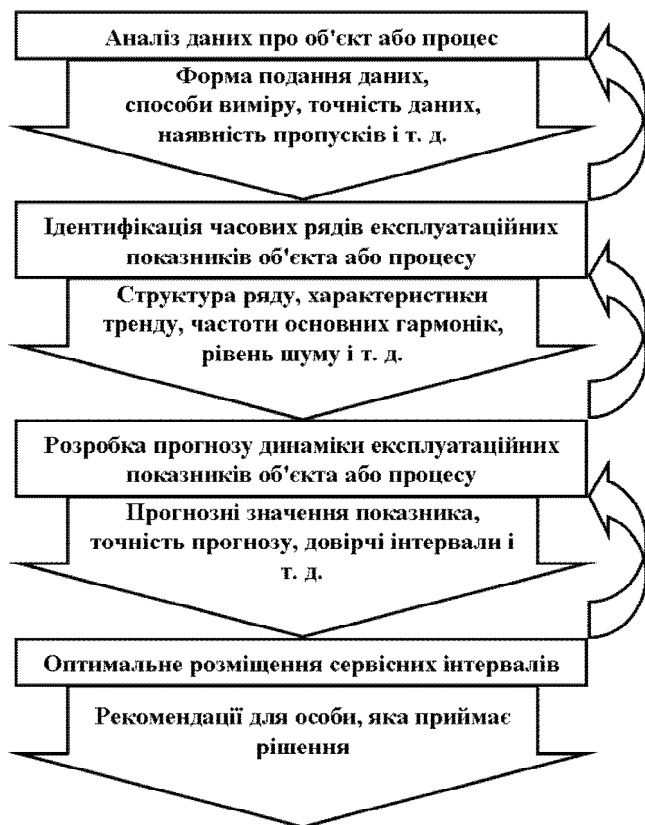
Рисунок 9 – Модель планування сервісних заходів на інженерних об'єктах ОТС
