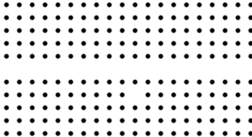
Рисунок 2.11 – Схема фотонно-кристалічного хвильоводу з резонатором
