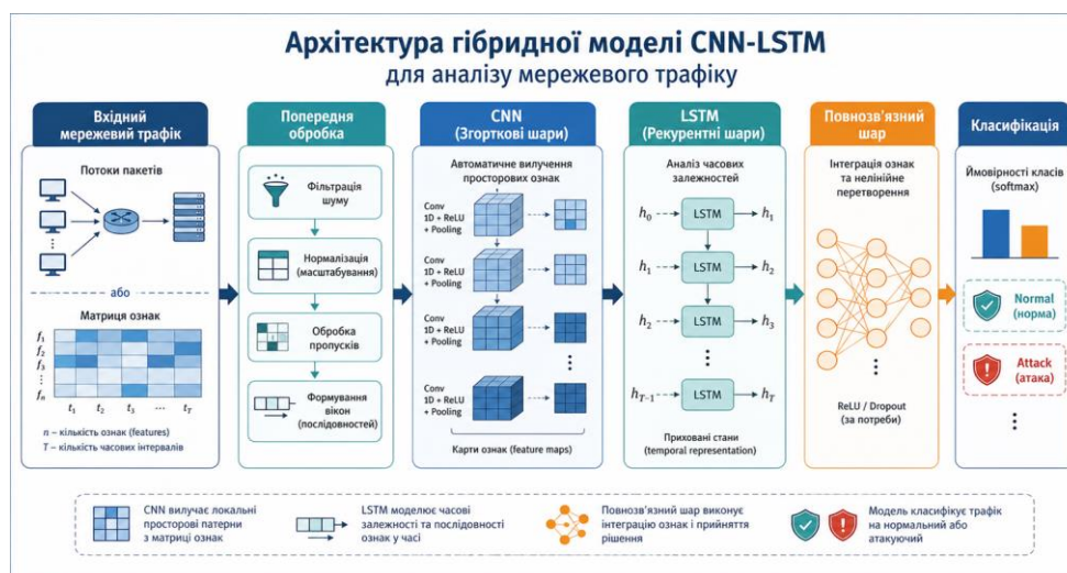
Рисунок 1.4 – Архітектура гібридної моделі CNN-LSTM для аналізу мережевого трафіку [5]
