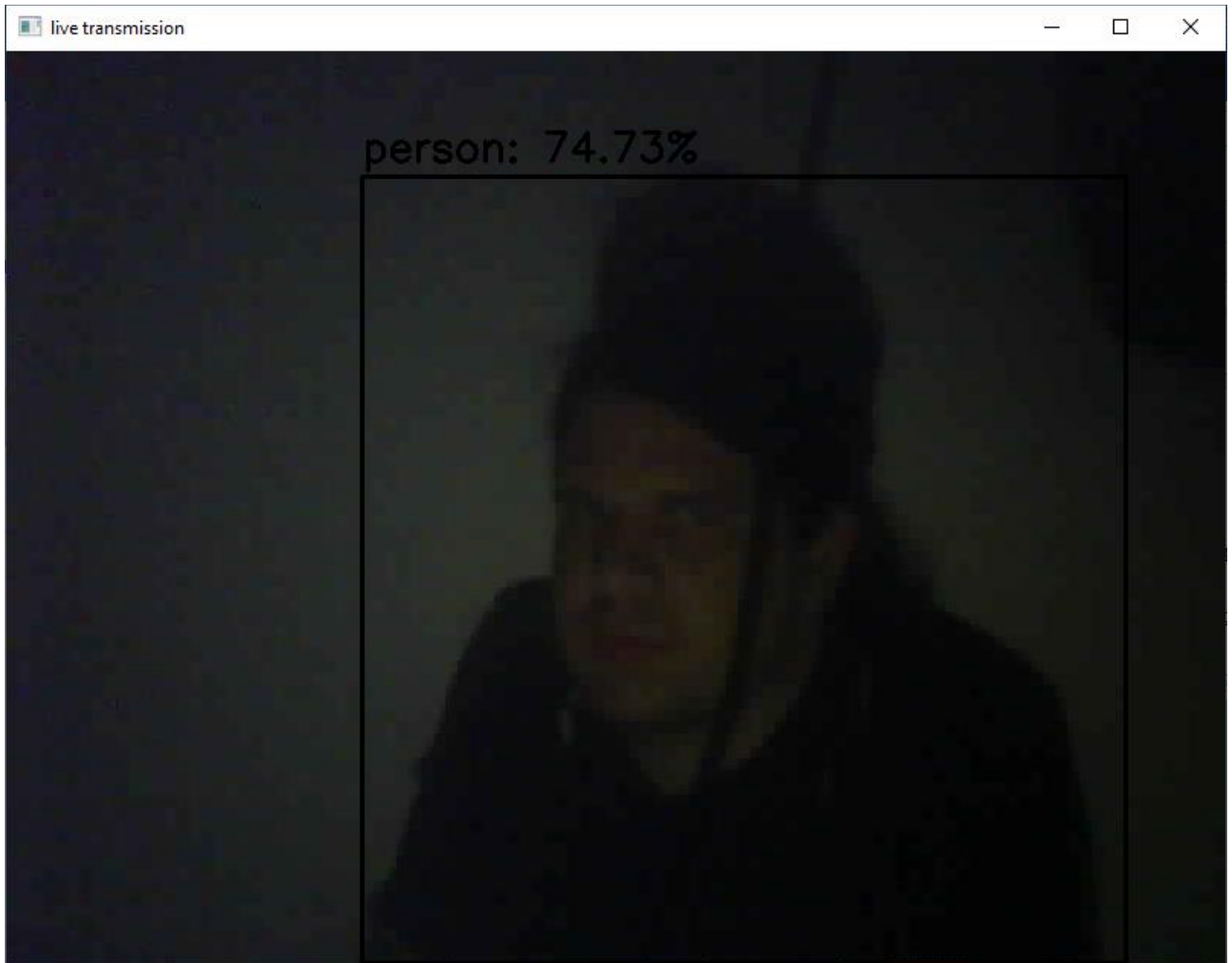
Рисунок 4.8 – Результат роботи при 15 люкс
