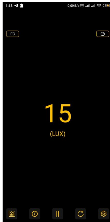
Рисунок 4.7 – Заміри люксометра при недостатньому освітленні
