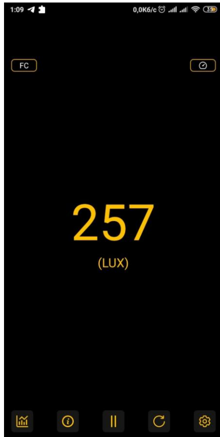
Рисунок 4.5 – Заміри люксометра при надмірному освітленні
