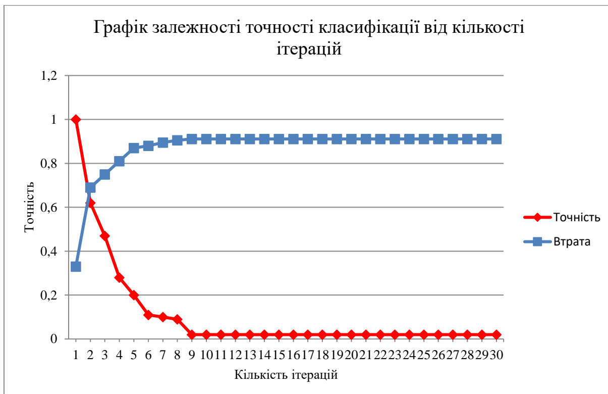
Рисунок 3.3 – Залежність точності класифікації та коефіцієнту втрати помилки від кількості ітерацій
