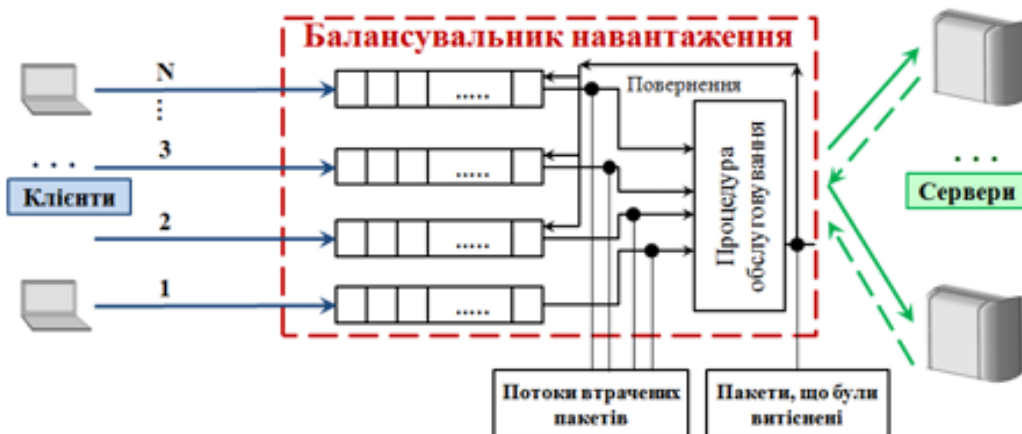
Рисунок 2 – Модель балансування навантаження в системі [3]
