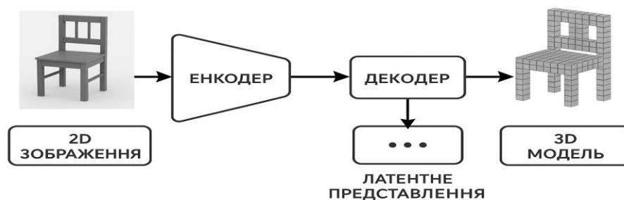
Рисунок 3.3 – Схема архітектури моделі (encoder–decoder)
