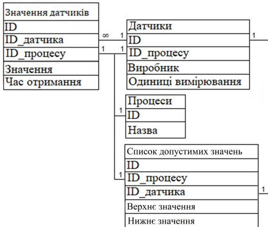
Рисунок 3.9 – Логічна модель бази даних для віддаленого серверу
