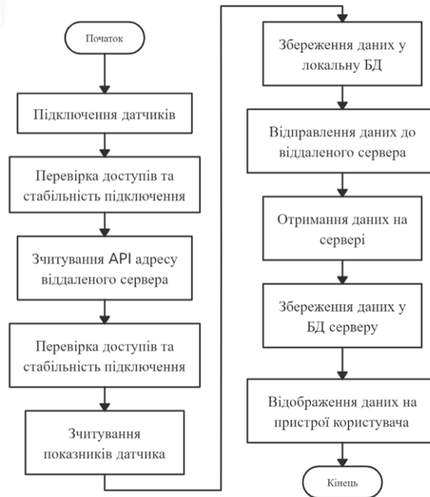
Рисунок 3.1 – Узагальнений алгоритм роботи макету системи моніторингу та візуалізації даних для кіберфізичних виробничих систем
