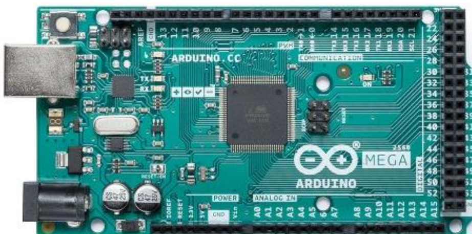
Рисунок 2.10 – Загальний вигляд Arduino Mega 2560 [30]
