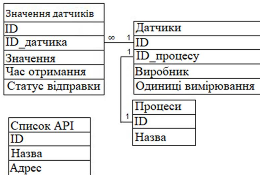
Рисунок 3.8 – Логічна модель бази даних для Raspberry Pi 4
