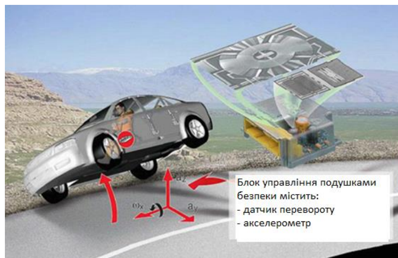
Рисунок 2.4 – Застосування акселерометра при перекиданні автомобіля
