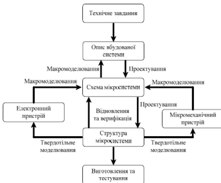
Рисунок 4.1 – Структурна схема проектування та виготовлення вбудованих систем
