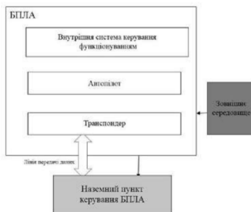
Рисунок 2.3 – Структура диспетчерського методу керування БПЛА
