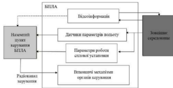
Рисунок 2.1 – Структура пілотажного методу керування БПЛА
