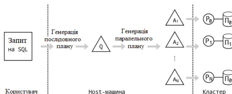
Рисунок 3.8 – Обробка запиту на основі фрагментного паралелізму
