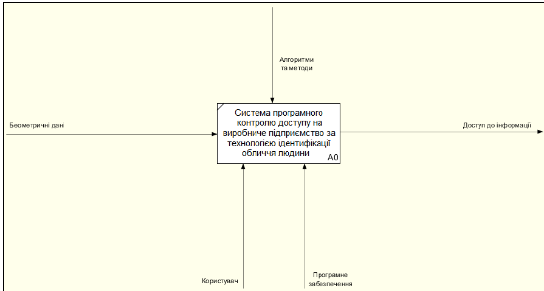
Рисунок 2.1 – Контекстна діаграма системи програмного контролю доступу на виробниче підприємство за технологією ідентифікації особи
