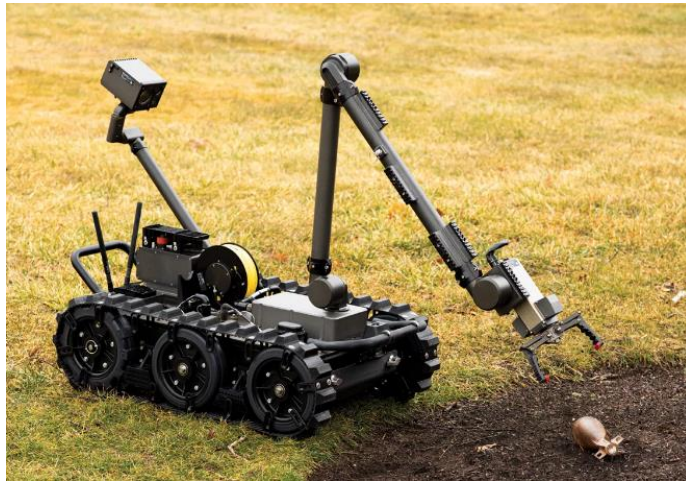
Рисунок 1.5 – Робототехнічний маніпулятор CENTAUR
