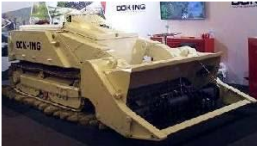
Рисунок 1.6 – Дистанційно-керована машина для розмінування MV-4
