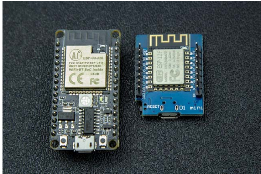
Рисунок 2.3 – Мікроконтролери ESP32 та ESP8266
