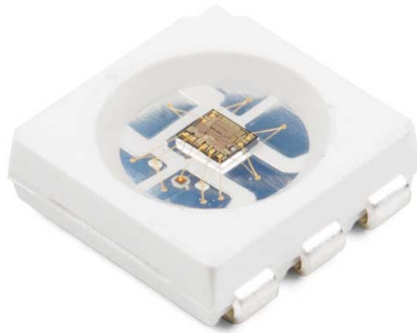
Рисунок 2.7 – Адресний світлодіод APA102
