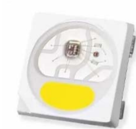
Рисунок 2.6 – Адресний світлодіод SK6812
