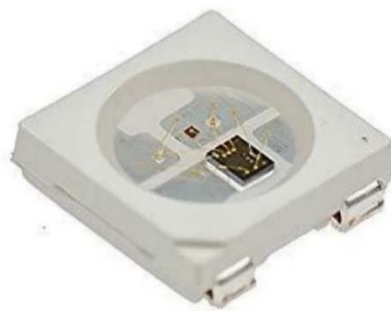
Рисунок 2.5 – Адресний світлодіод WS2812B
