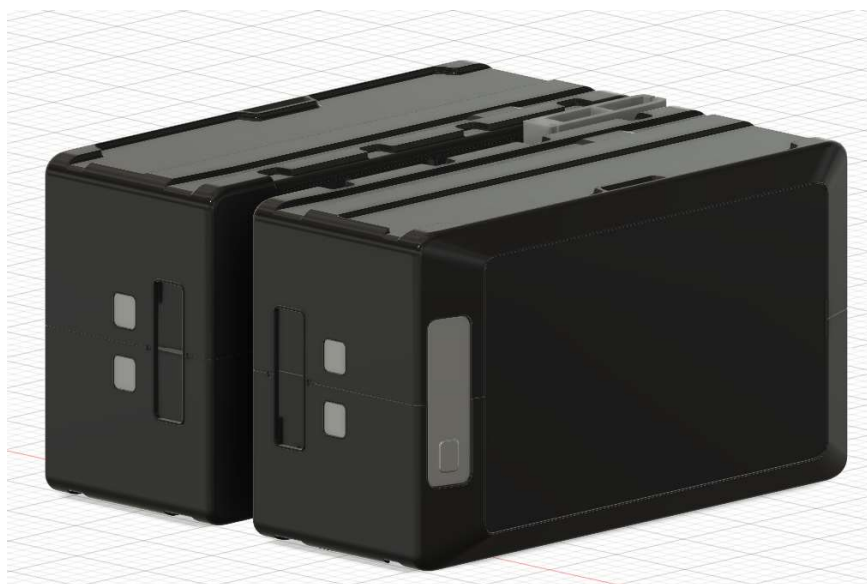
Рисунок 2.2 – Розроблена модель зовнішнього акумулятора для повітряного робота
