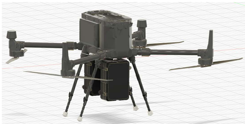
Рисунок 3.19 – Демонстрація платформи на повітряному роботі, до якої приєднано два окремих кейси
