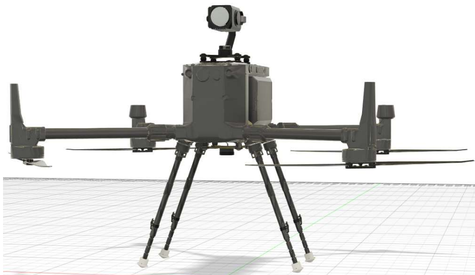
Рисунок 3.4 – Змодельований повітряний робот з конструкцією перевезення різногабаритних вантажів з електромагнітом
