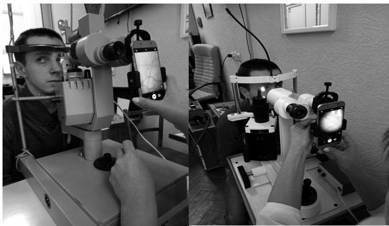
Рис. 1. Зовнішній вигляд апаратної частини щілинних ламп, які використовувалися в роботі для отримання відеоданих.
