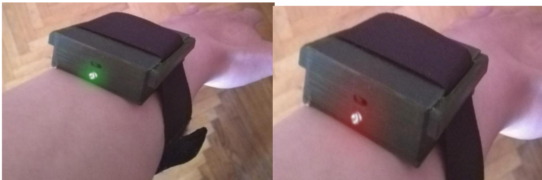
Рисунок 4.4 – Коректна робота приладу (а) та індикація розрядженого акумулятора (б)
