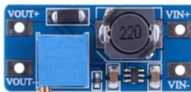
Рисунок 2.9 – DC-DC перетворювач напруги MT3608
