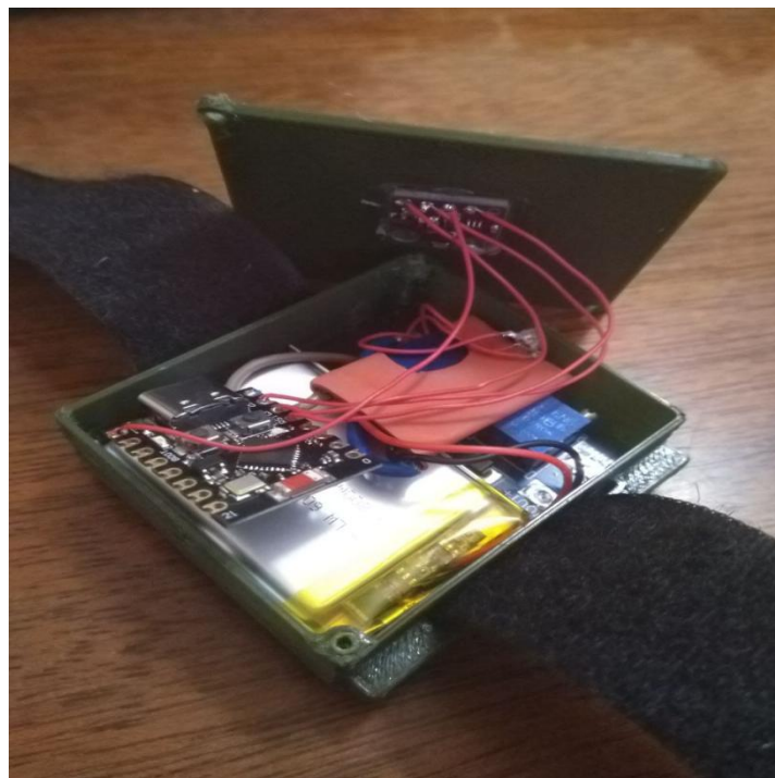
Рисунок 2.19 – Фіксація компонентів пристрою у корпусі
