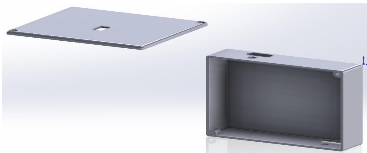
Рисунок 2.13 – Детальна модель корпусу приладу
