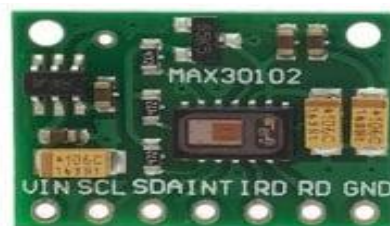
Рисунок 2.3 – Оптичний датчик MAX30102 для зчитування ЧСС
