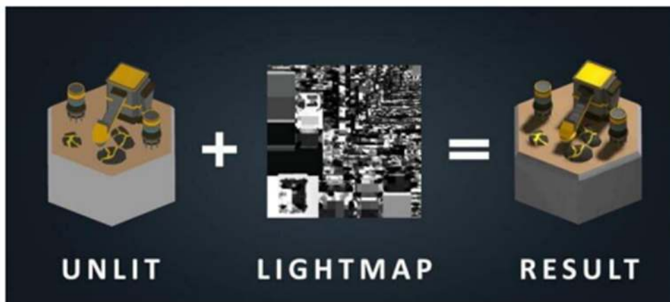
Рис. 1. Процес запікання тіней у текстуру, щоб не прораховувати їх у реальному часі
