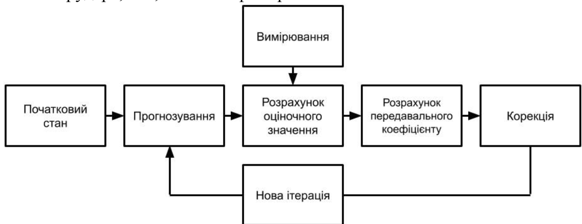
Рис. 1 – Етапи роботи фільтра Калмана при оцінці положення екструдера
