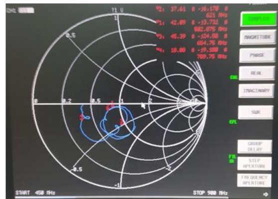
Комплексний вхідний опір на діаграмі Сміта
