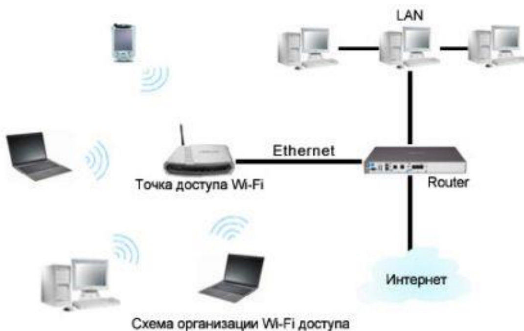
Рисунок 1.4 – Схема організації доступу Wi-Fi
