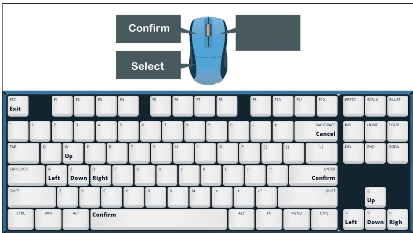
Рисунок 4.28 – Схема управління меню з клавіатури та миші
