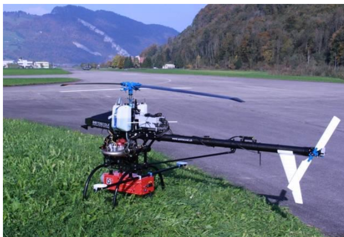
Рисунок 3.5 – Безпілотний апарат з встановленим лідаром та гіперспектральною камерою
