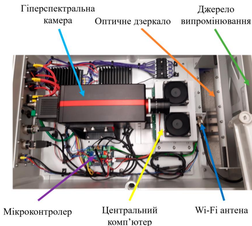
Рисунок 3.8 – Внутрішня будова системи дистанційної гіперспектральної візуалізації
