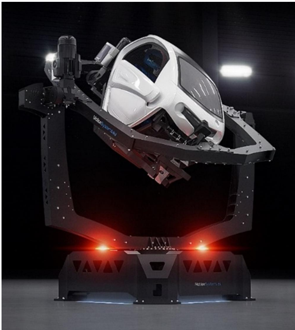
Рисунок 1.6 – Навчальний комплекс на базі динамічної платформи PS-3ROT
