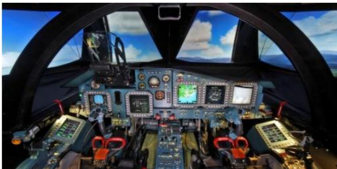
Рисунок 1.5 – Навчальний комплекс на базі динамічної платформи PS-3ROT-150 вигляд з середини
