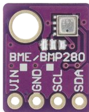
Рисунок 2.6 – Зовнішній вигляд та опис виводів модулю BME280
