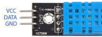
Рисунок 2.5 – Зовнішній вигляд та опис виводів модулю KY-015
