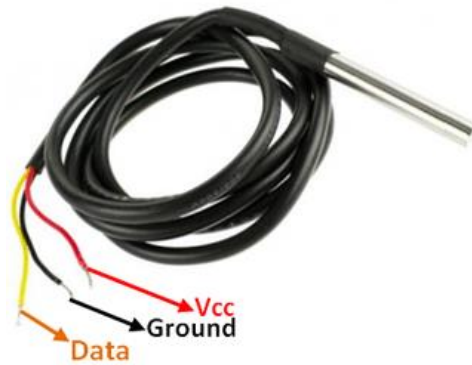
Рисунок 2.7 – Зовнішній вигляд та опис виводів датчику DS18B20
