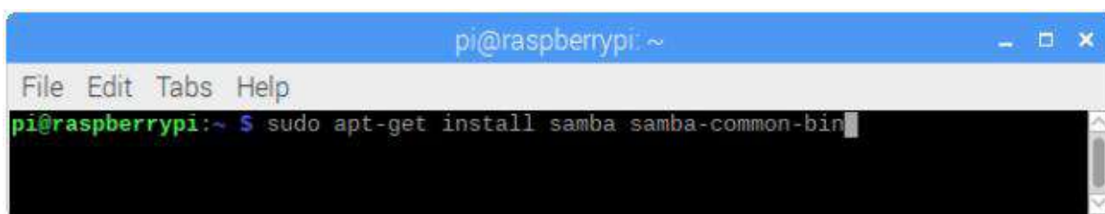
Рисунок 4.22 – Команда для установки Samba у терміналі
