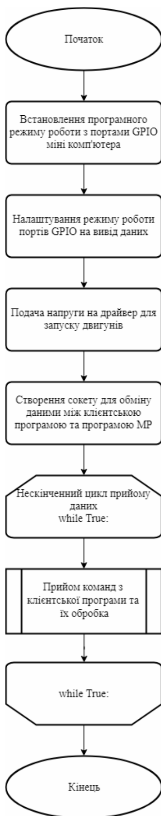
Рисунку 6.7 – Узагальнена схема алгоритму серверної програми керування MP
