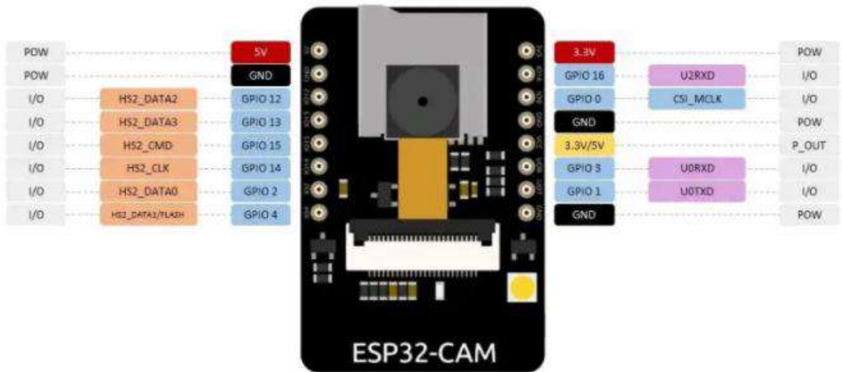
Рисунок 2.23 – Розпіновка виводів EI ESP32-CAM
