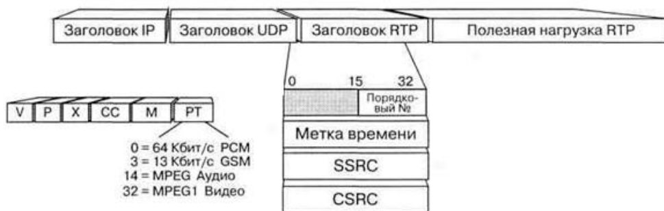
Рисунок 2.8 – Структура пакета RTP
