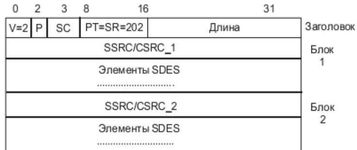
Рисунок 2.11 – Формат RTCP пакета опису джерела
