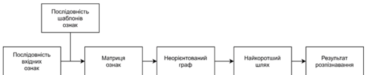
Рисунок 2.3 – Повна модель алгоритму розпізнавання динамічного типу жестів
