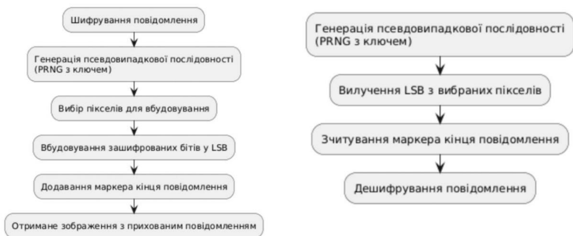
Рисунок 2.1 – Процес вбудовування та вилучення прихованого повідомлення
