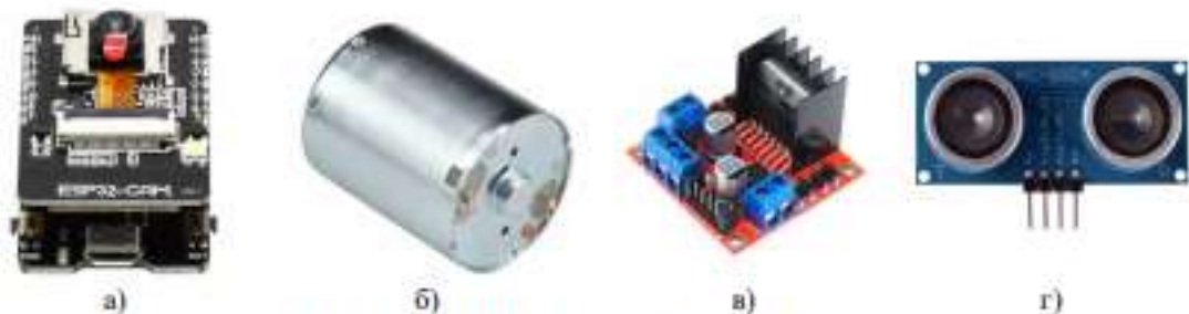
а) ESP32-CAM; б) Hobby-370 DC 12 V 6600 RPM; в) Драйвер двигуна L298N; г) Ультразвуковий сенсор HC-SR04
