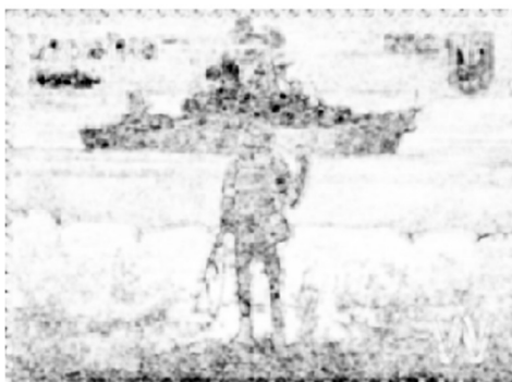
Рисунок 9 – SSIM мапа, де чорним кольором позначено значну різницю між еталонним та спотвореним зображеннями
