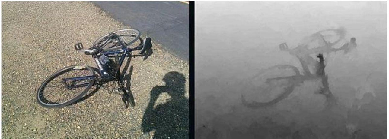
Рисунок 1.6 – Приклад карти глибини отриманий за допомогою камери Google Pixel 2
