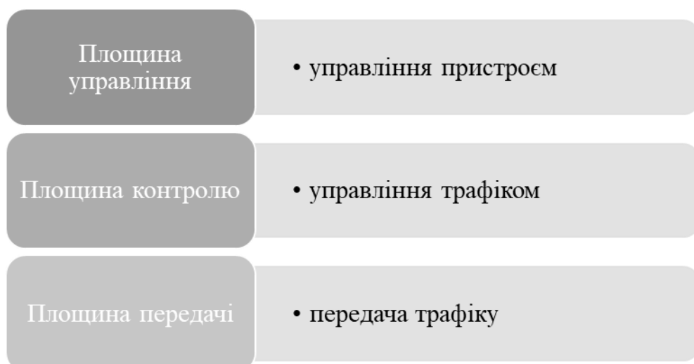
Рисунок 1.1 – Архітектура SDN-мережі у загальному вигляді
