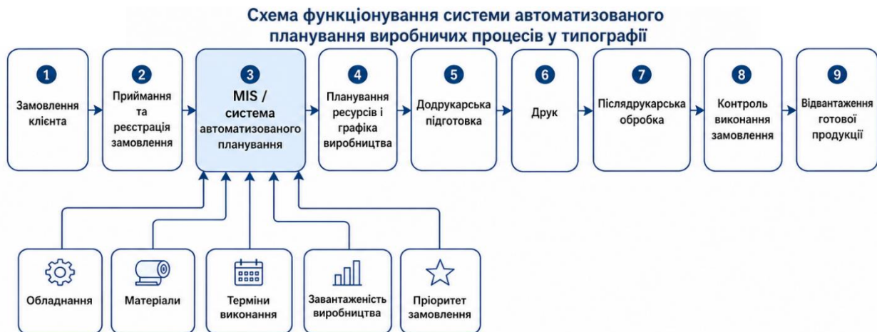
Рисунок 1 – Схема функціонування APS виробничих процесів у типографії
