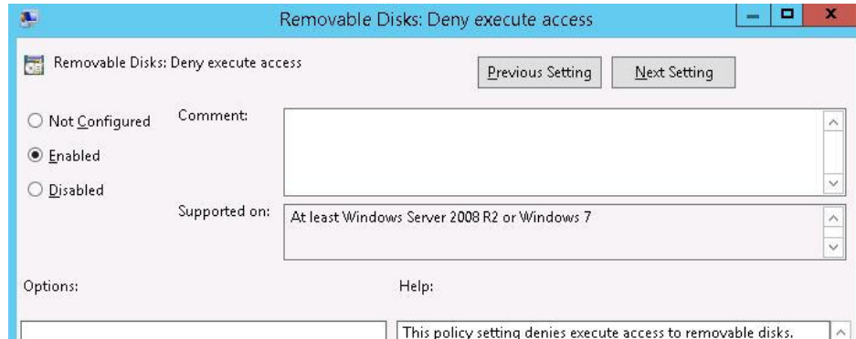
Рисунок 4.9 - Налаштування політики, що блокує запуск виконуваних файлів та скриптів з USB-дисків
