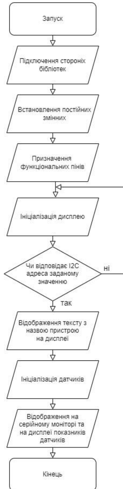
Рисунок 3.3 – Алгоритм роботи макету системи контролю якості рідини
