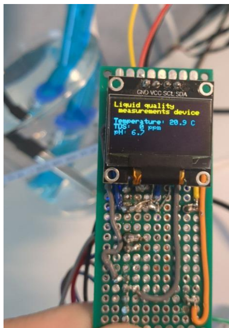
Рисунок 3.15 – Результат вимірювання кислотності у дистильованій воді
