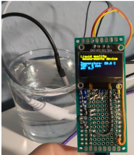
Рисунок 3.14 – Результат вимірювання у дистильованій воді
