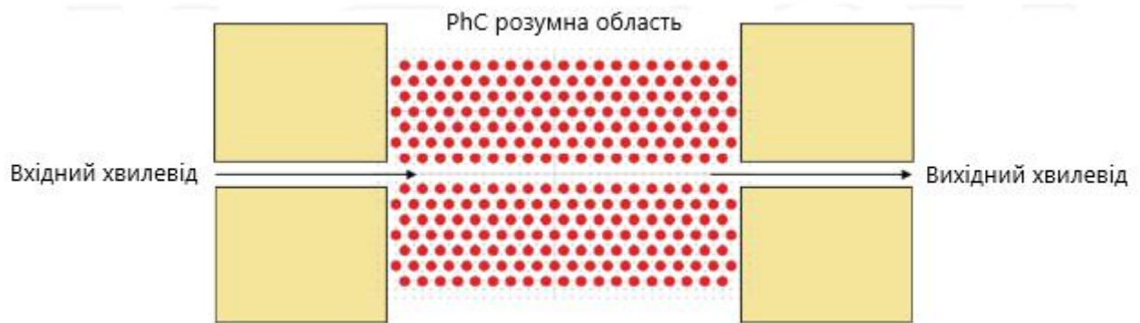
Рисунок 1.11 – Схема ДНК-сенсора на основі ФК, що характеризується вхідним і вихідним одномодовими хвилеводами шириною 500 нм
