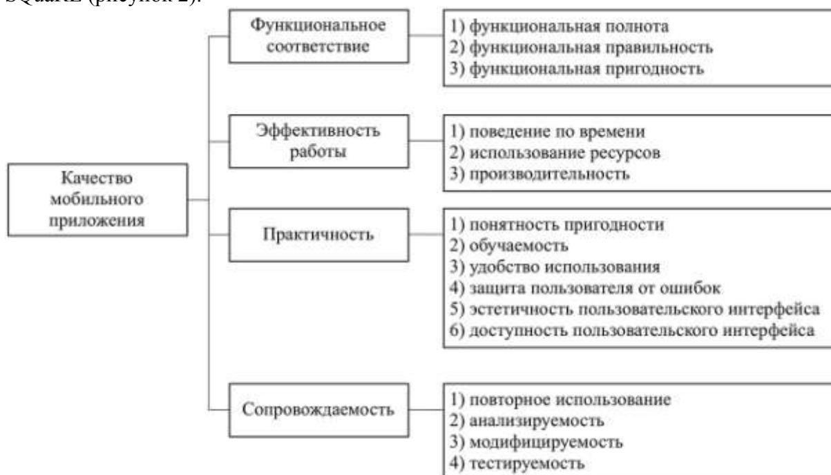
Рисунок 2 – Модель качества приложений мобильных устройств
