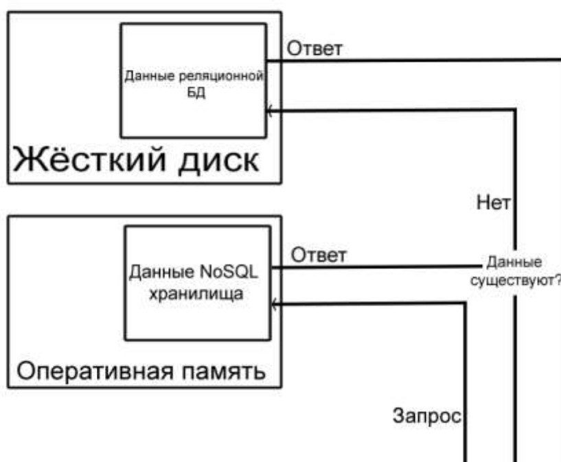
Рисунок 1 – Схема работы Nosql хранилища с реляционной БД
