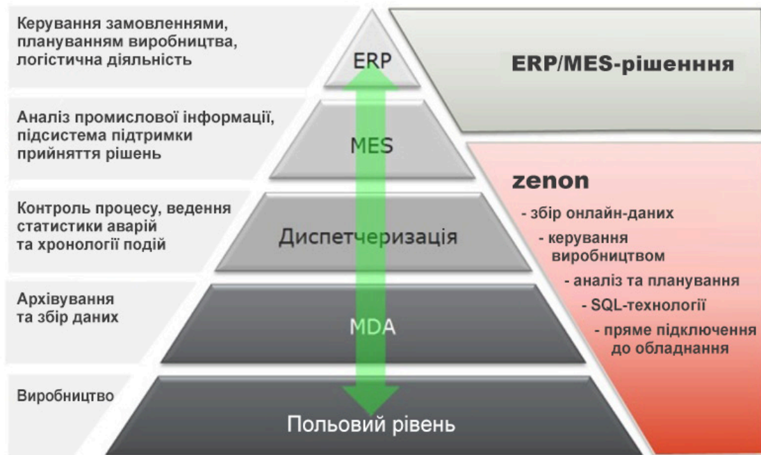
Рисунок 1.1 – Архітектура типової SCADA-системи
