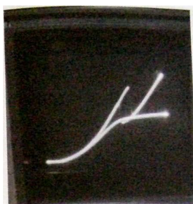
Рисунок 3.10 – Експериментальні ВАХ елементів монолітно-інтегрованого РТД та MESFET
