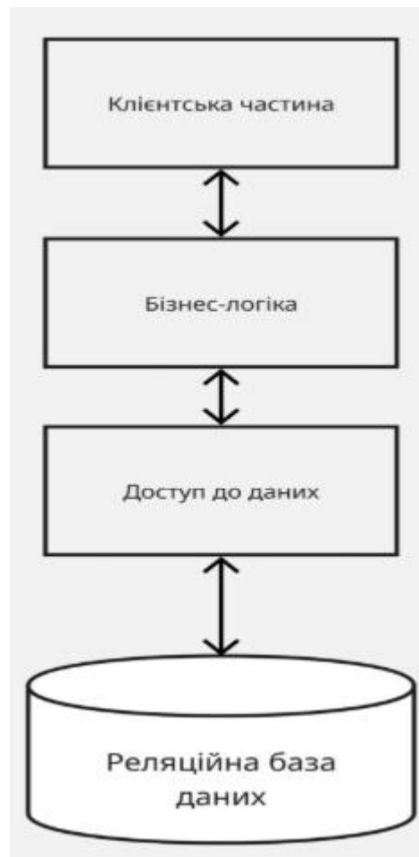
Рисунок 2.3 - Схема тривірневої архітектури веб-додатку
