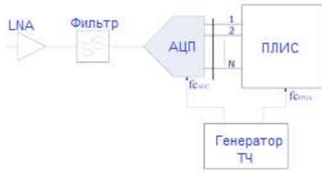
Рисунок 3.1 – Структурна схема, що описує роботу повністю цифрового приймача широкосмугового сигналу
