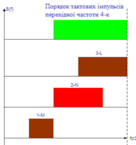
Рисунок 3.3 – Реальний спектр дискретизованого сигналу з інтермодуляційними складовими внаслідок нелінійної роботи АЦП
