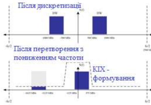
Рисунок 3.6 – Розглянутий випадок: спектр сигналів після дискретизації на АЦП і після широкосмугового перетворення з пониженням частоти.
