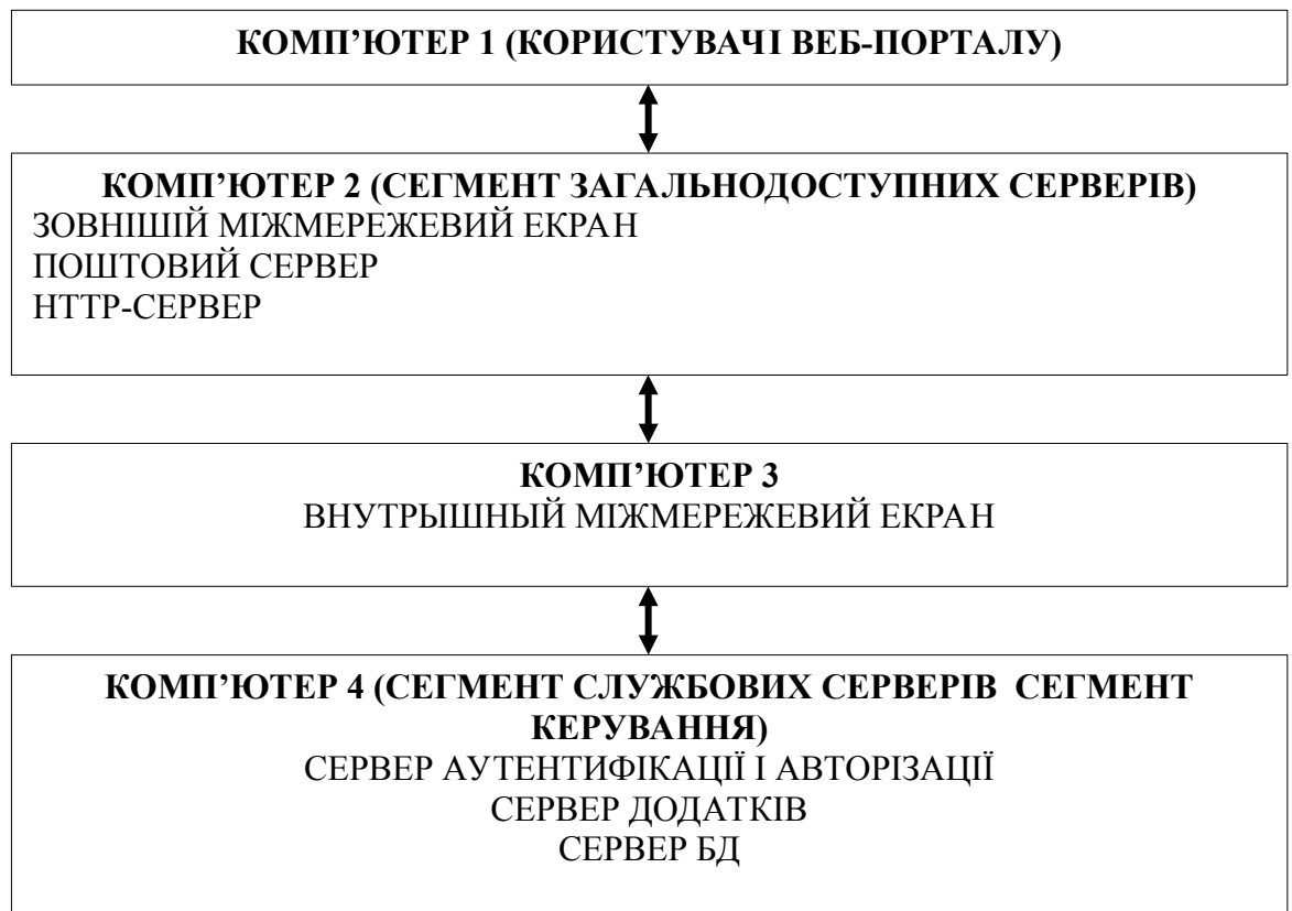
Рисунок 3.1 – Логічна модель мережі веб-сайту, що використана при проведенні досліджень
