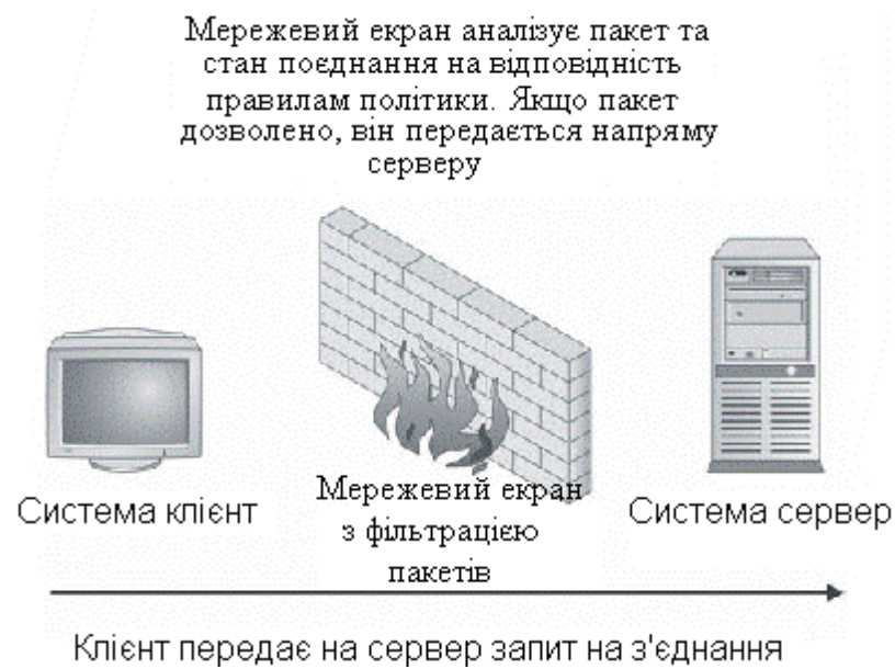
Рисунок 2.2 – Передача трафіка через міжмережевий екран з фільтрацією пакетів
